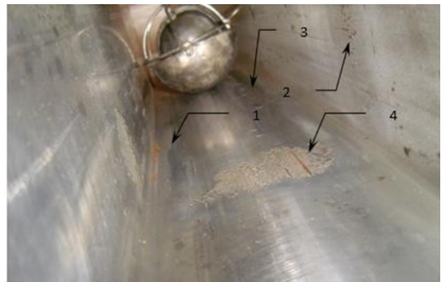
Рис. 3. Руйнування хромового покриття гільзи
