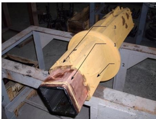
Рис. 2. Гільза в обичайці (1 — мідна гільза; 2 — обичайка з нержавіючої сталі; 3 — гвинти, що центрують, для фіксації гільзи)
