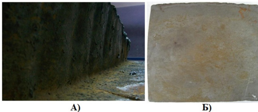
Рис. 7. Хвилястість на внутрішній поверхні твердої оболонки заготовки (а) та деформація заготовки у поперечному перерізі (б) при швидкості розливання 3,7 м/хв
