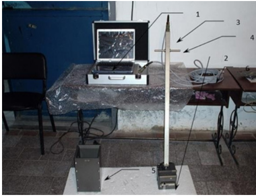
Рис. 1. Вимірювальна система MCS – 3000 виробництва фірми CONCAST: Система складається з ноутбука 1, вимірювальної головки 2, колони 3, рукоятки 4, контрольного калібру 5, кабелю 6.
