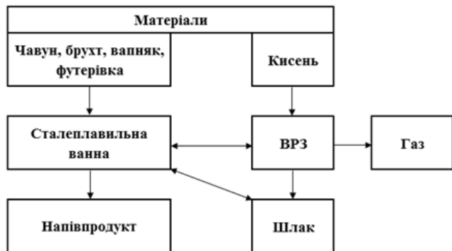
Рис. 1. Схема взаємодії сталеплавильної ванни з високотемпературною реакційною зоною
