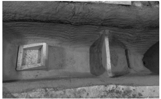
Рис. 6. Промежуточный ковш с установленными в него элементами системы УФС
