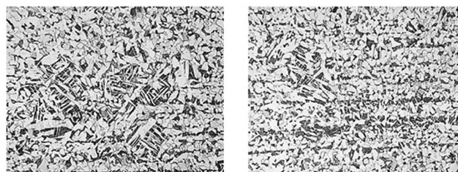
Рис. 4. Фрагменты микроструктуры металла исследованных горячекатаных трубных заготовок из котельной стали 20, \times 100 (уменьшено в 1,4 раза)
