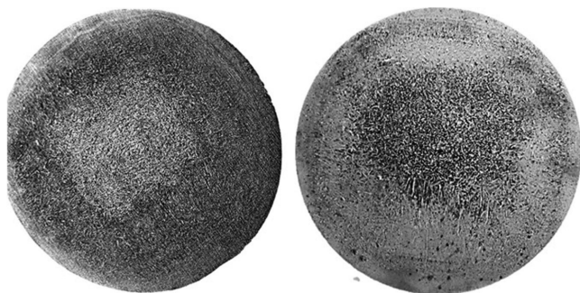
Рис. 2. Характерный вид макроструктуры металла исследованных горячекатаных трубных непрерывнолитых заготовок стали 20, \times 0,4
