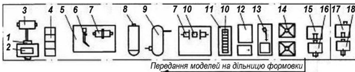
Рис. 3. Схема комплектації основним обладнанням модельної дільниці для ЛГМ: 1 – установка для підспіювання гранульованого полістиролу, що має 2 – водно-парову ванну і 3 – автоклав; 4 – накопичувальні бункери; 5 – стелд для складання-розкладання прес-форм; 6 – пристрій для задування ППС в 7 – прес-форми; 8 – автоклав; 9 – ванна з холодною водою; 10 – модель; 11 – стелаж; 12 – стіл; 13 – пристрій для фарбування; 14 – сушильна камера; 15 – універсальний складальний стелд; 16 – 3D-фрезер; 17 – складальний стелд; 18 – 3D-принтер
