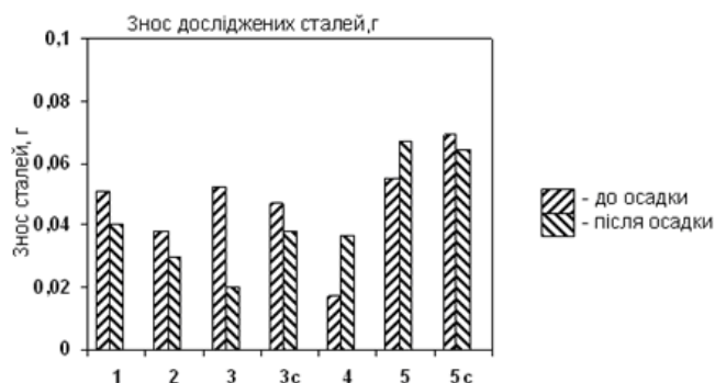
Рис. 4. Знос досліджених сталей в умовах сухого тертя ковзанням: № 1 (стандартна сталь); № 2 (N); № 3 (V+N) — після гартування; № 3 (V+N) — після гартування та старіння; № 4 (N+Ti+Nb); № 5 (N+V+Ti+Nb+Ce) — після гартування; № 5с (N+V+Ti+Nb+Ce) — після гартування та старіння
