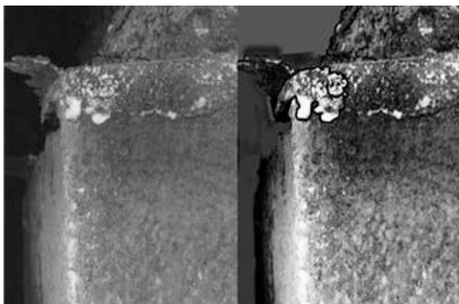
Рис. 6. НаноАрт «Ведмідь», створений на прикладі заливини, що утворилася на великому листовому зливку в результаті затікання металу під прибуткову надставку
