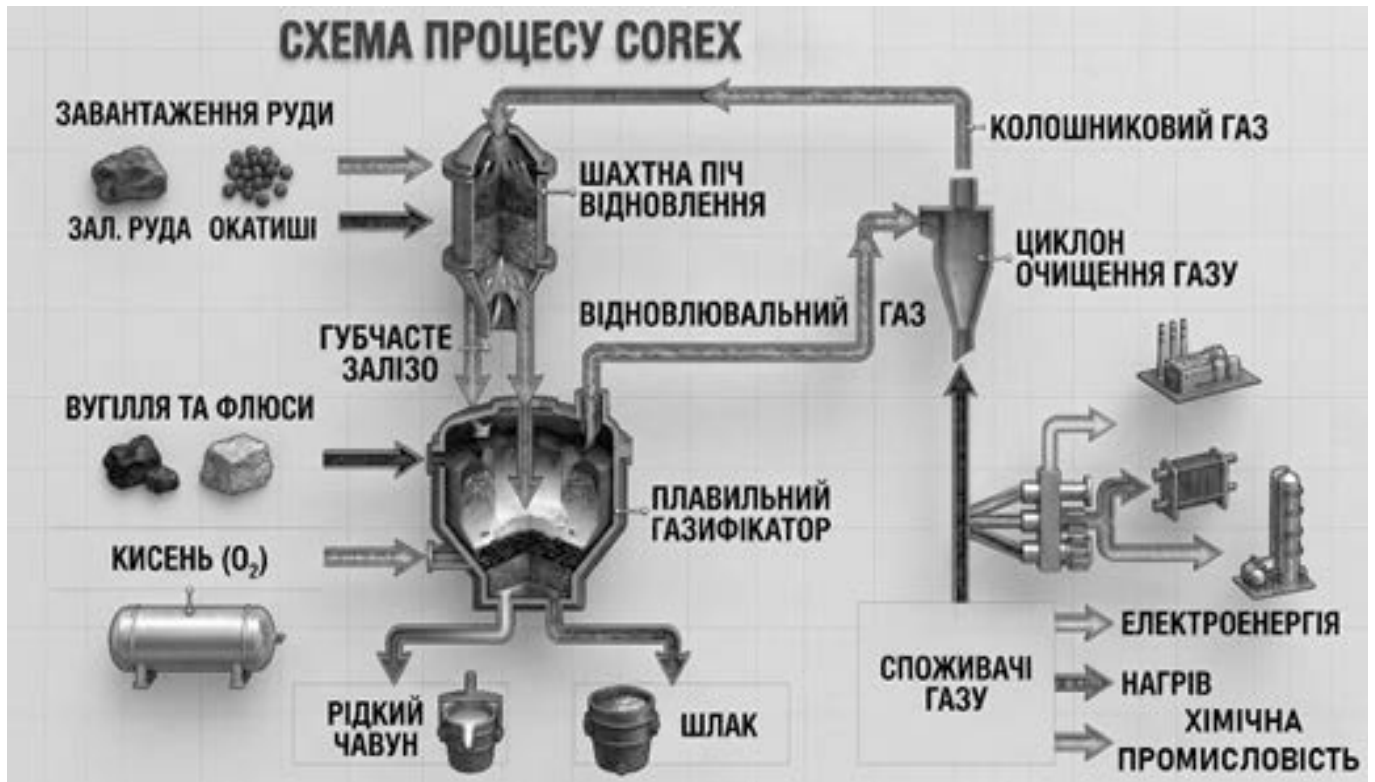
Рис. 2. Принципова схема Corex-процесу
