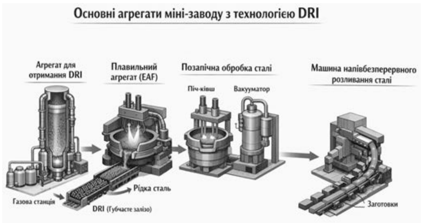
Рис. 3. Принципова схема Міні-заводу
