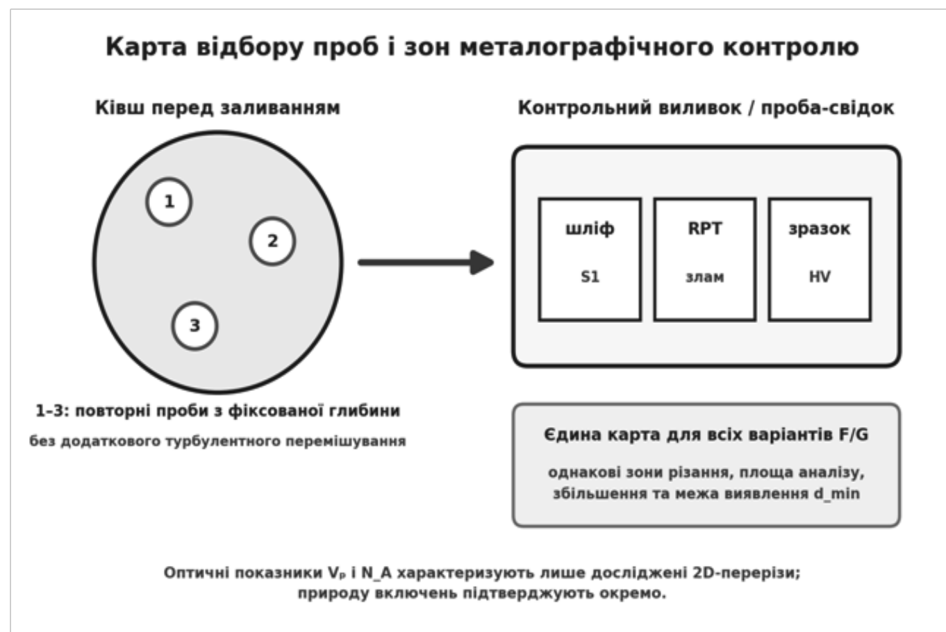
Рис. 5. Карта відбору проб і стандартних зон металографічного контролю
